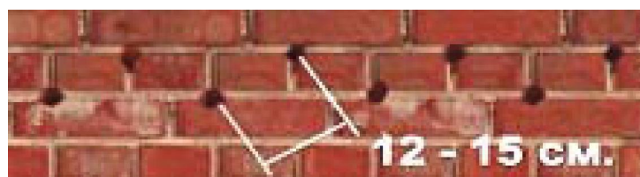
Рисунок 4.9 – Схема размещения шпуров
